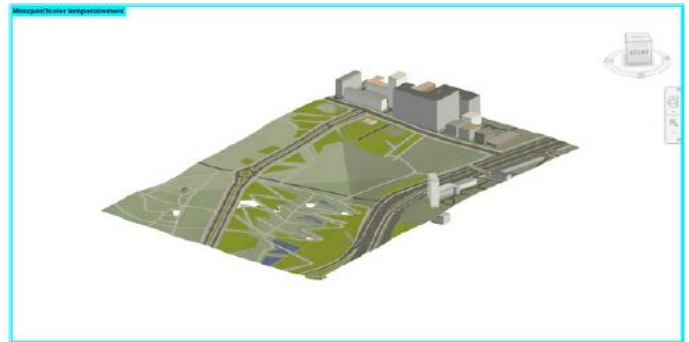
Fig. 1 Le site du Heydar Aliyev Center, initialement élaboré dans Autodesk InfraWorks, est importé dans Revit pour constituer le socle de la maquette
