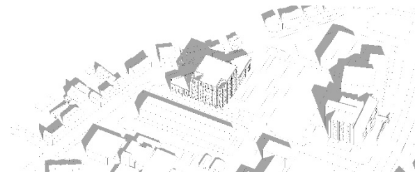
Figure 3 - Modèle traditionnel de vérification de l'impact d'ensoleillement au 21 mars à 9h00 via l'outil SketchUp.
