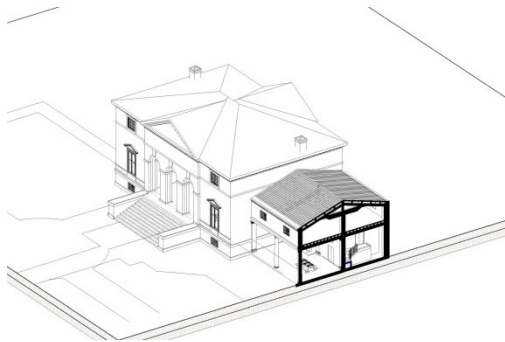
Figure 14 – Détail de la structure en bois sur une vue.
